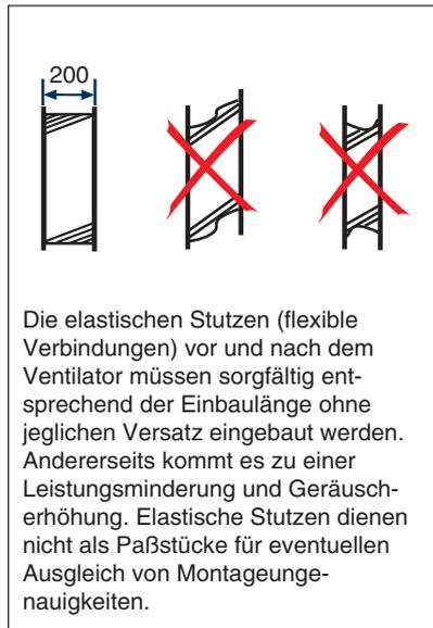
Die elastischen Stutzen (flexible Verbindungen) vor und nach dem Ventilator müssen sorgfältig entsprechend der Einbaulänge ohne jeglichen Versatz eingebaut werden. Andererseits kommt es zu einer Leistungsminderung und Geräusch-erhöhung. Elastische Stutzen dienen nicht als Paßstücke für eventuellen Ausgleich von Montageun- genauigkeiten.
